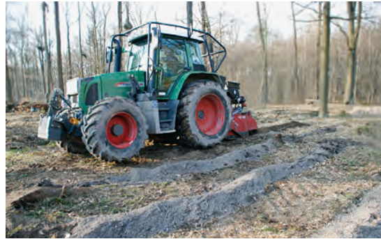
Abb. 5: Fräsen von Pflanzstreifen mit gleichzeitiger Kalkeinbringung
